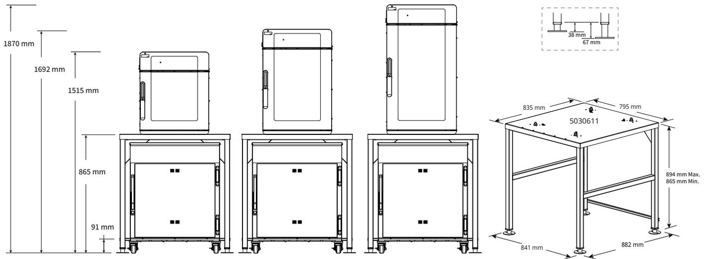
Указанные размеры приведены с регулируемыми ножками, зафиксированными на минимальной высоте.
