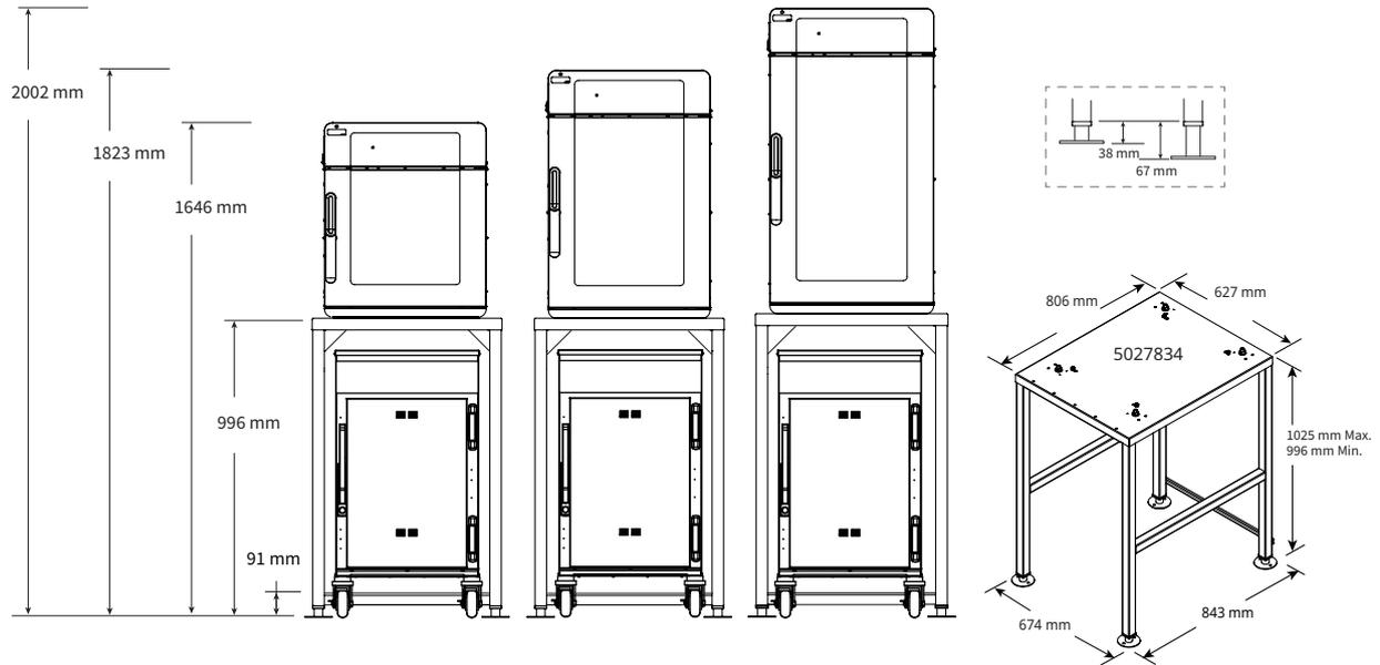
Указанные размеры приведены с регулируемыми ножками и колесами, зафиксированными на минимальной высоте.
