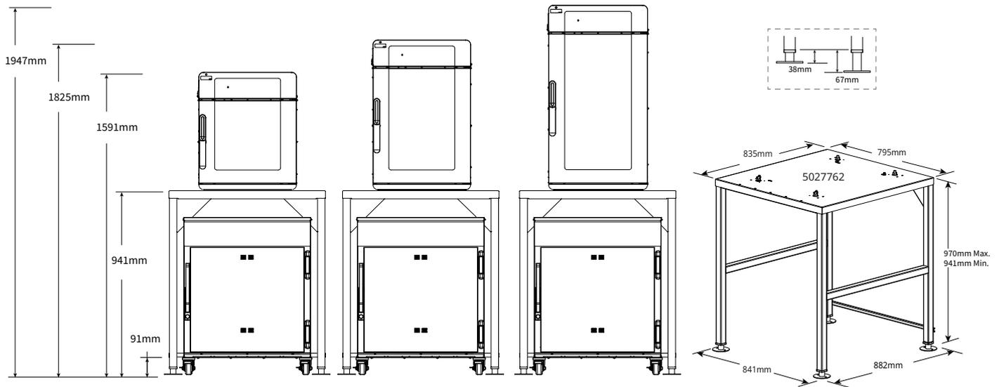
Указанные размеры приведены с регулируемыми ножками, зафиксированными на минимальной высоте.
