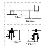
Указанные размеры приведены с регулируемыми ножками и колесами, зафиксированными на минимальной высоте.
