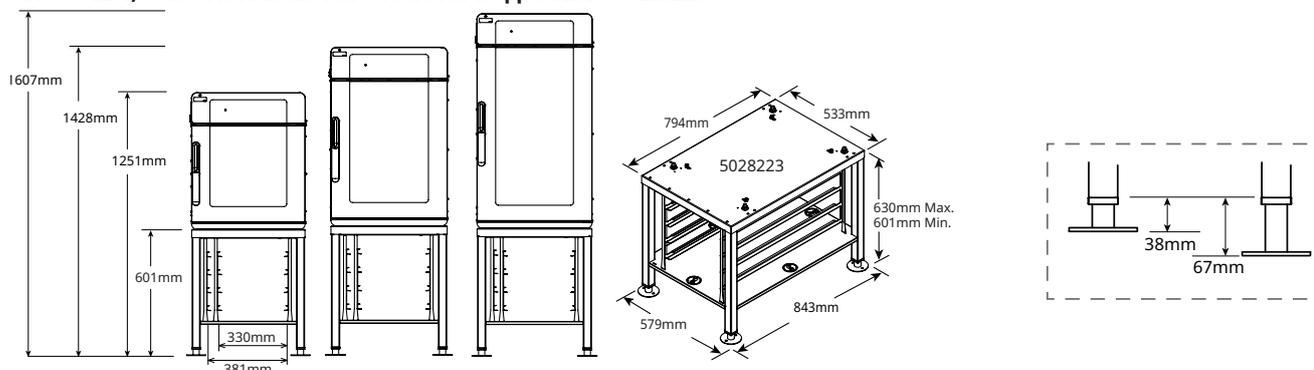
Указанные размеры приведены с регулируемыми ножками, зафиксированными на минимальной высоте.
