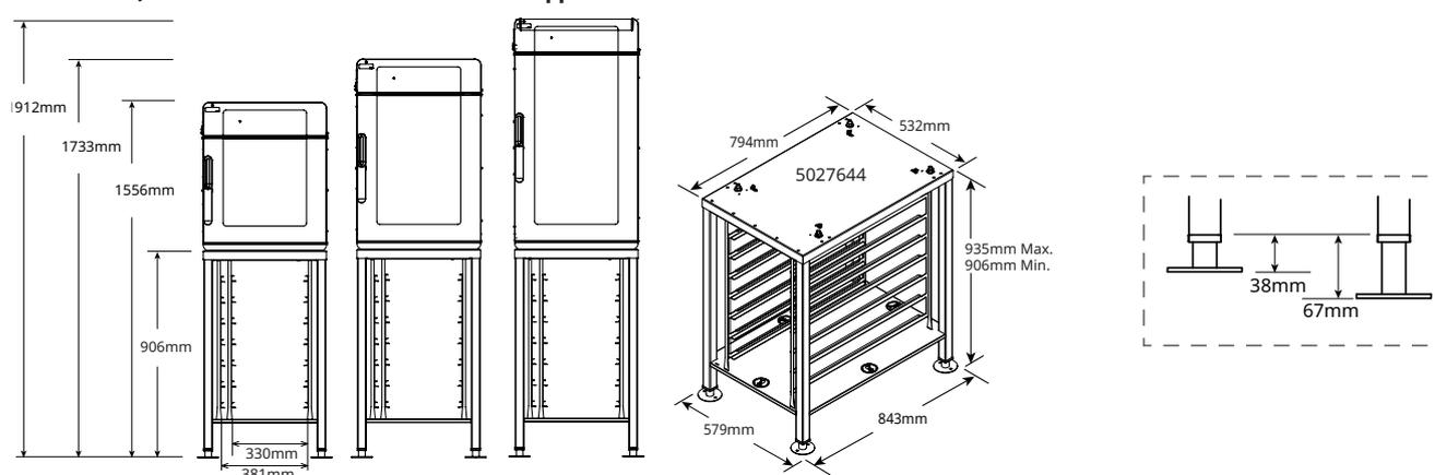
Указанные размеры приведены с регулируемыми ножками, зафиксированными на минимальной высоте.
