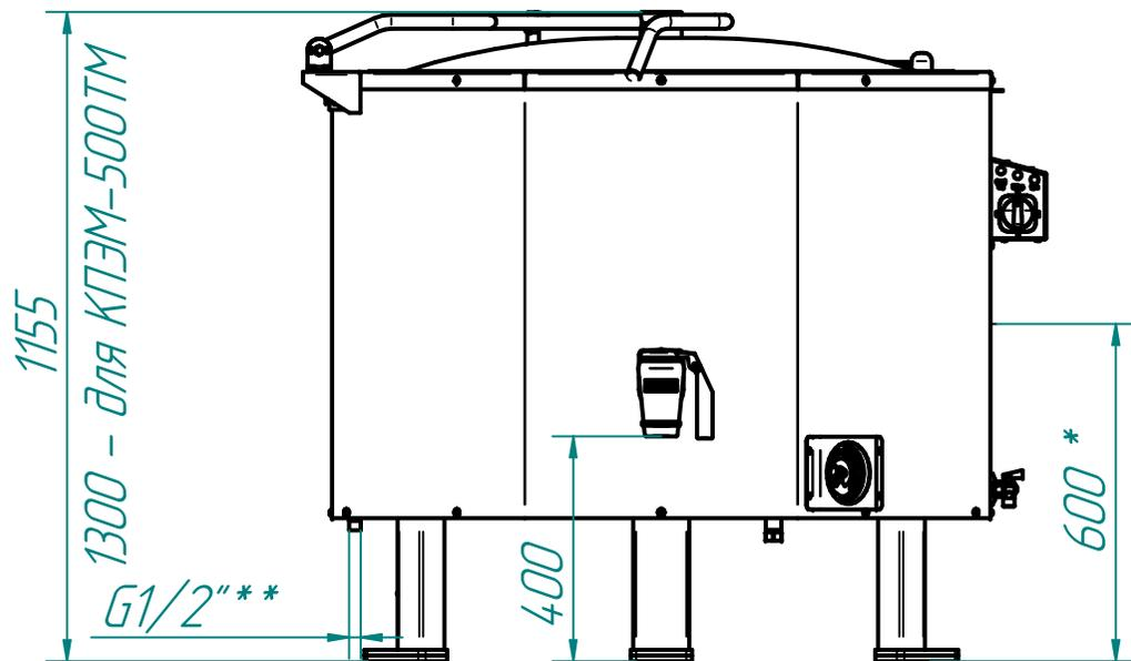
Котелы пищеварочные электрические типа КПЭМ предназначены для приготовления бульонов, третьих блюд, кипячения воды. Имеют три режима нагрева. Слив готового продукта осуществляется краном 2" на лицевой панели. Удобная ручка крышки фиксируется в любом положении. Нагрев воды осуществляется способом "пароводяной рубашки". При отсутствии воды в "пароводяной рубашке" срабатывает автоматическое отключение котлов. Котел поставляется с монтажными лапами, крепящимися к полу фундаментными болтами М10х100.
