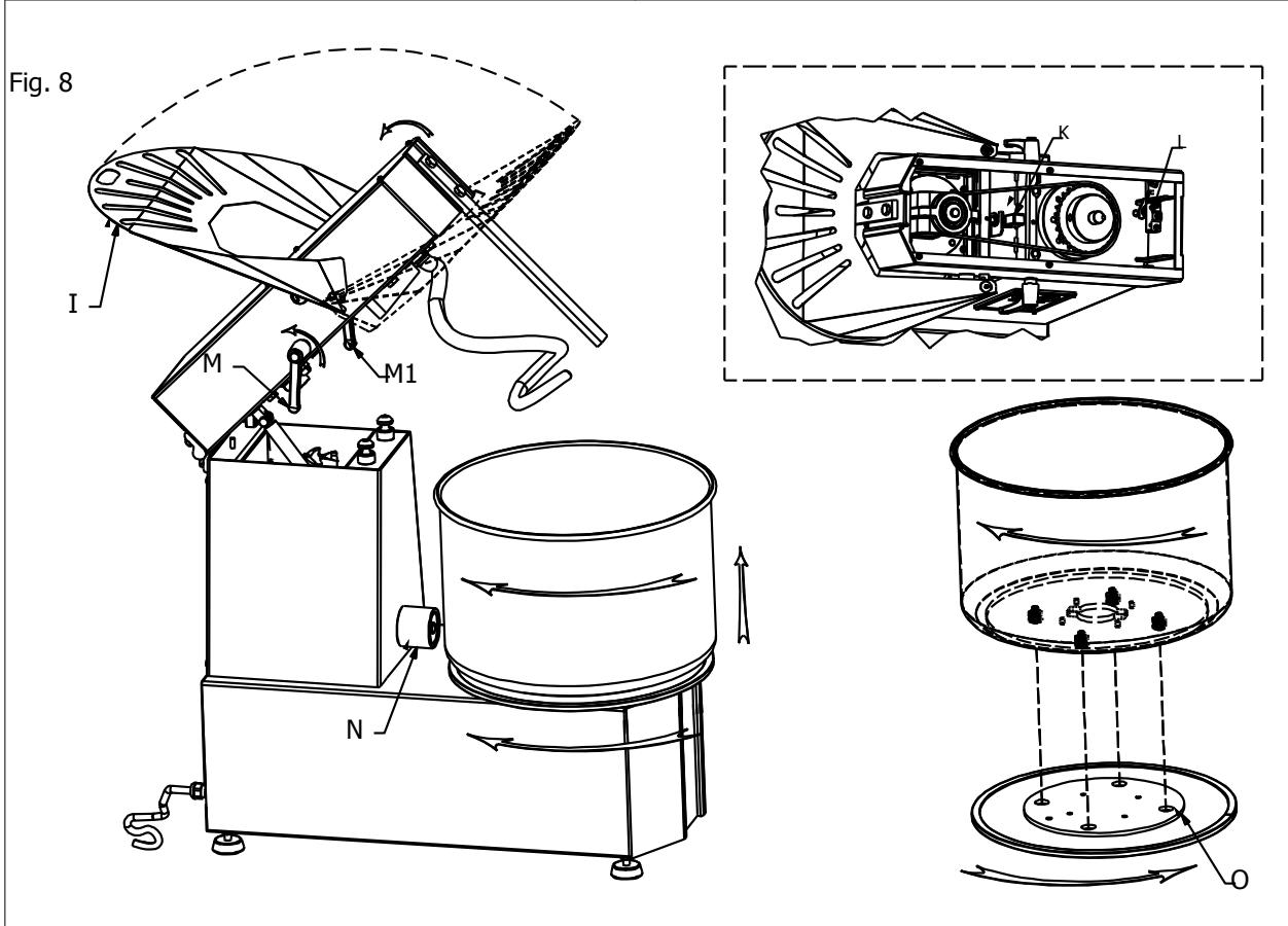
Перед запуском машины (пуск в эксплуатацию) полностью опустите головку Р и защиту I (РИС. 9). У открывающихся моделей проверьте, что ванна правильно установлена и заблокирована диском О и что головка в горизонтальном положении заблокирована ручками М и М1, которые должны быть полностью затянуты. После того, как был вставленна вилка в розетку электропитания, машина готова к функциональной проверке.
