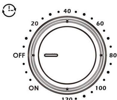
Установите желаемое время, поворачивая регулятор таймера по часовой стрелке, загорится световой индикатор.
