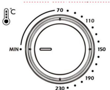
Используя регулятор температуры, Вы можете установить температуру в диапазоне 70 – 230°C
