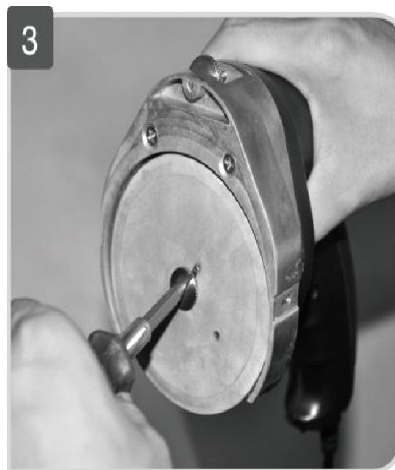
Рис.6 Снятие защитного кожуха, снятие диска
