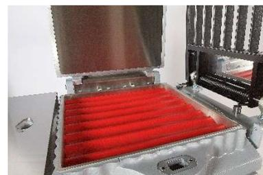
Модель Robotrad-s Form: Формовочные делители с боковой формовочной решеткой и формовочной пластиной.
