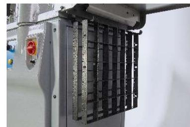
Крючки для 6 решеток с одной или обеих сторон машины.
