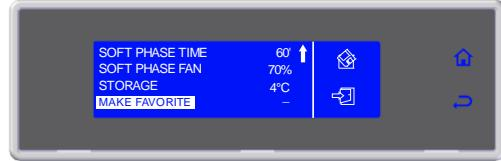
Для включения цикла в избранные выбрать команду **НАЗНАЧИТЬ ИЗБРАННЫМ**, расположенную в конце списка параметров, и ввести желаемую позицию. Цикл будет автоматически перезаписан на место цикла, расположенного на этой позиции.
