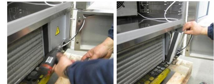
Удалить фиксирующие винты электрического щита.
