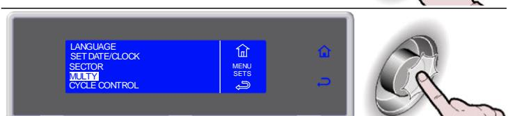
7. Выбрать число уровней, соответствующих используемому аппарату, поворачивая ручку
