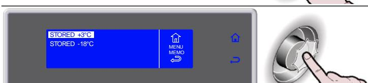
7. Выбрать поворачивая ручку желаемый цикл
