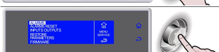
7. Отобразить список аварийных сигналов поворачивая ручку
