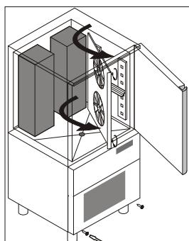
Вымыть простой водой дверную прокладку и аккуратно вытереть ее сухой тряпкой. Одевать всегда защитные перчатки.
