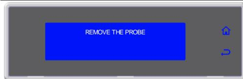
В случае, если температура, определенная игольчатым зондом внутри продукта, не является отрицательной, функция не будет активирована.
