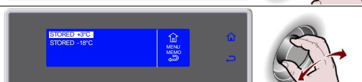
6. Нажать рукоятку для входа в желаемый тип цикла
