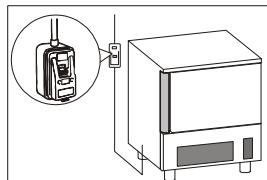
Электрическое подключение выполняется в задней части аппарата.
