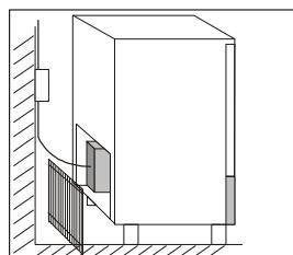
Модели с конденсирующей установкой на расстоянии подсоединяются раздельно с аппаратом и с установкой.
