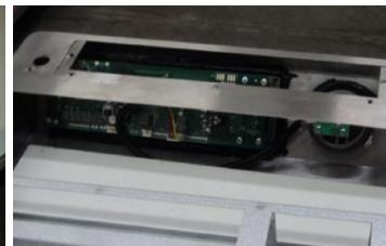
Ослабьте винты и снимите крышку для доступа к видеокарте и датчик
