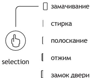
**Только стирка и отжим:** эта функция заполнит стиральную машину, а затем обеспечит перемешивание стирки. В конце сливает воду и отжимает бельё, чтобы завершить цикл. Индикатор вращения останется включённым.
