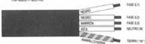
400 VOLTOS TRIFÁSICO + NEUTRO
