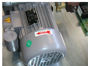
Figura 5.2. Freccia indicante il senso di rotazione.
