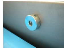
Figura. 7.1 Ugello di aspirazione
