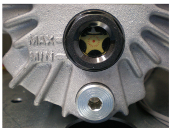
Figura 5.1. Indicatori di livello olio della pompa.
