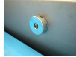
Figura. 7.1 Ugello di aspirazione
