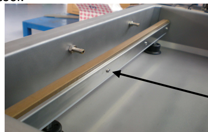
Figura 8.1. Barra saldante presente all'interno della vasca.
