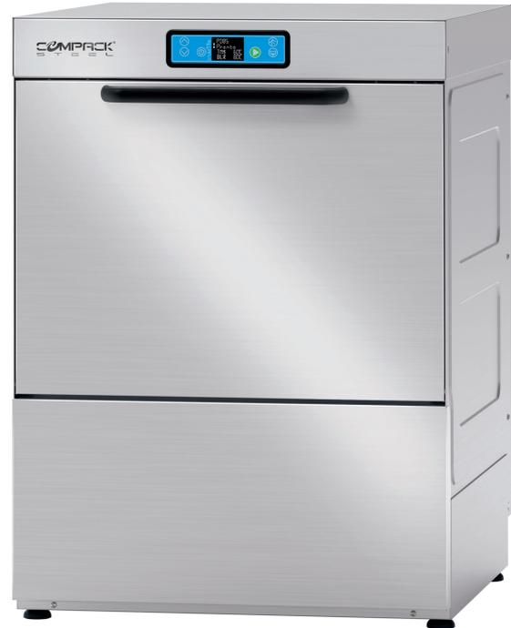
Модели линии PLUS оснащены автоматическим умягчителем, который эффективно справляется с образованием известкового налёта. Смягчитель полностью автономен и автоматически регулирует свои интервалы регенерации в зависимости от жёсткости воды на входе; вам необходимо только заполнять солевой бак каждый раз, когда на дисплее появляется сообщение «Нет соли». Регенерация смол происходит во время циклов мытья, поэтому останавливать машину не требуется.
