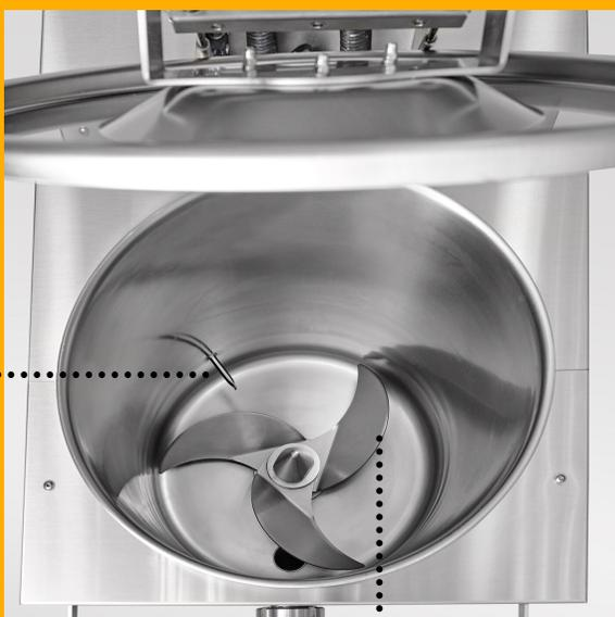
Кювета оснащена мешалкой (пропеллером) и датчиком температуры
