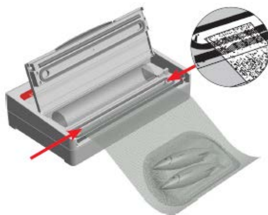
Рисунок 6: Для вакуумной упаковки поместите наполненный пакет в центр вакуумного канала (между черными уплотнителями из пеноматериала).
