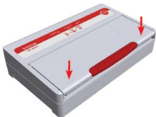
Рисунок 2: Закройте прибор. Нажмите на места, маркированные 1 и 2.
