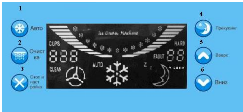
Рис. 1 Дисплей панели управления. Отображения основных функций. Кнопки управления.
