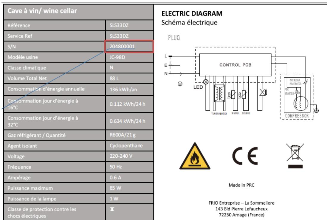
Заводская табличка, прикрепленная к внутренней или задней части устройства(в зависимости от модели), содержит всю относящуюся к нему информацию.
