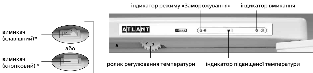
Рисунок 1 – Морозильник та комплектуючі вироби
