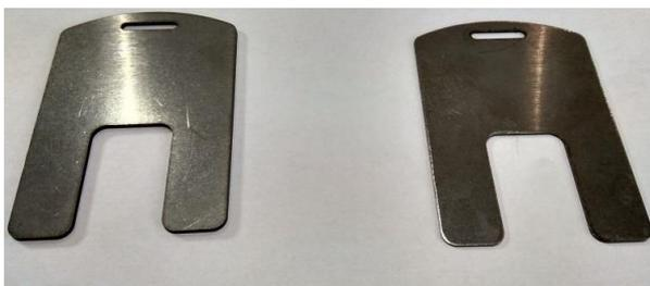
Фото 9. Регулировочные вкладыши
