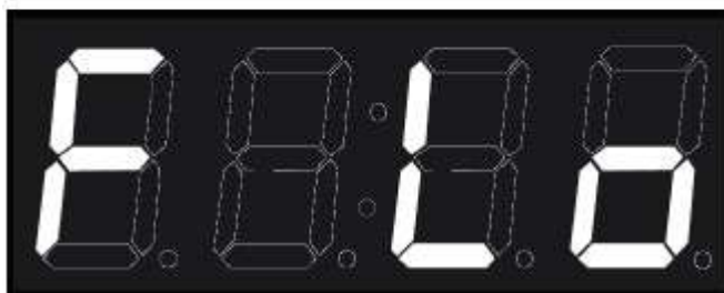
Максимальная скорость (Hi) и ограниченная скорость (Lo)
