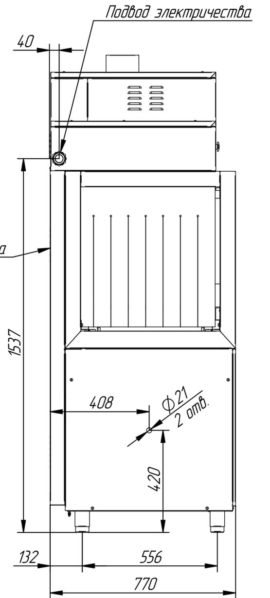
Схема подключения машины МПТ-2000
