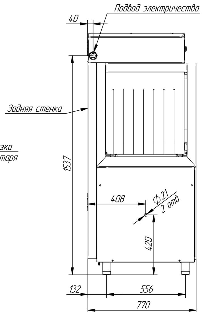
Схема подключения машины МПТ-1700-01
