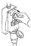
Posizionare a “zero” il dispositivo di protezione posto a monte della linea d’alimentazione dell’equipaggiamento elettrico.
