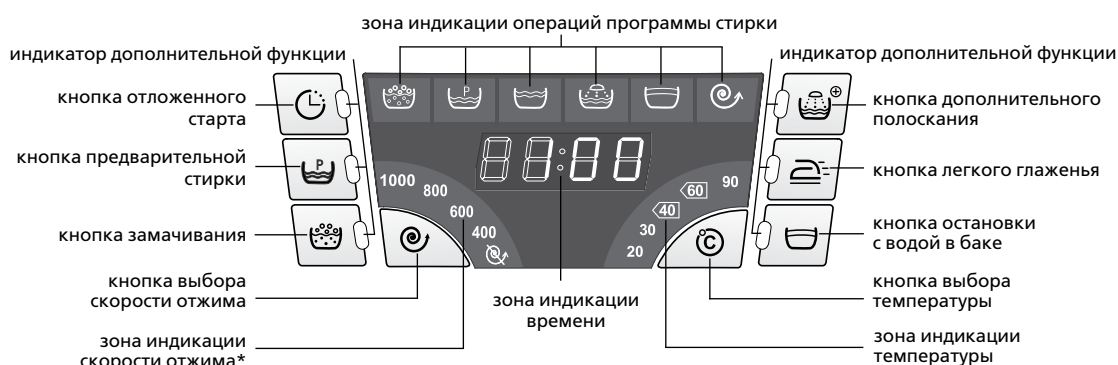
Рисунок 3 – Дисплей и кнопки управления
