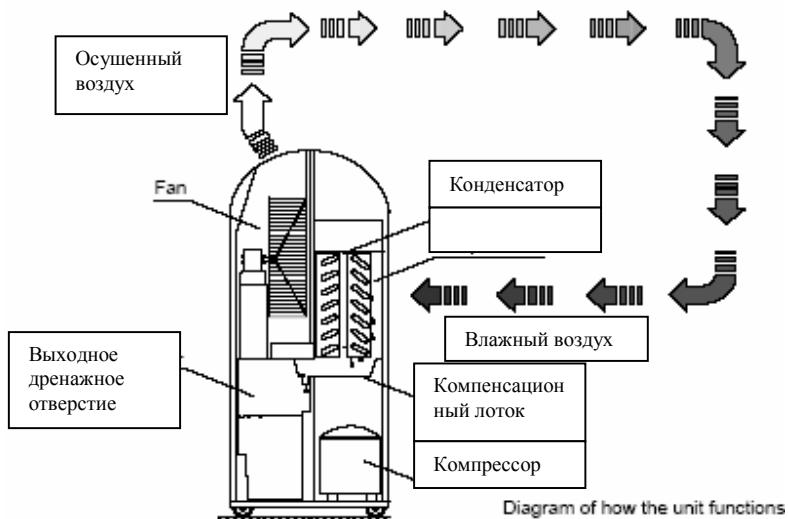
Осушенный, охлажденный воздух вновь разогревается в **конденсаторе** (радиаторе), а затем выводится наружу с температурой примерно на 5 градусов выше комнатной температуры. Этот воздух, который теперь стал сухе, вновь смешивается с окружающим воздухом. Относительная влажность воздуха постепенно сокращается до желательного значения относительной влажности, с помощью непрерывной циркуляции внешнего воздуха через установку.
