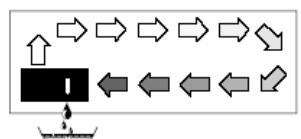
Поток воздуха охлаждается по пути сквозь/через испаритель-конденсатор, пока его температура не опускается ниже температуры точки росы. Водяной пар конденсируется и собирается в конденсационном лотке и дренируется.
