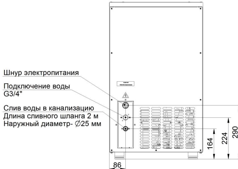
Рис. 4 Схема подключения льдогенератора
