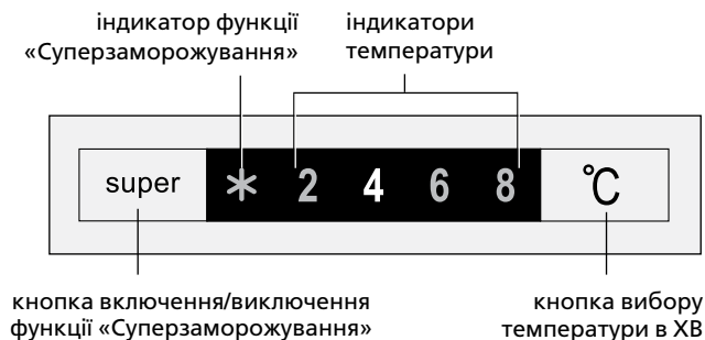
Малюнок 3 – Панель керування
