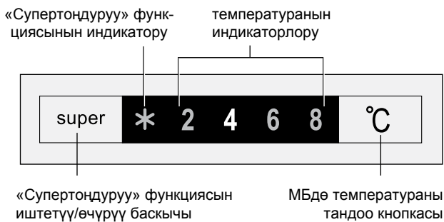
3-сүрөт – Башкаруу панели
