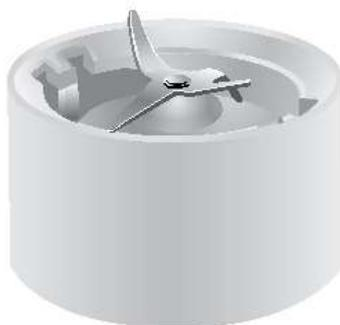
2. Установите уплотнительное кольцо плоской стороной вниз вокруг ножей и в канавку в фиксирующем кольце.
