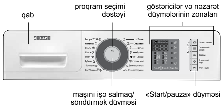
Şəkil 1 – İdarəetmə paneli
