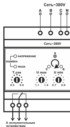
Схема подключения реле контроля фаз РКФ
