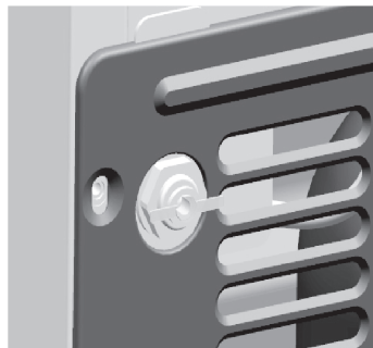
2. Снимите пылезащитный колпачок.
