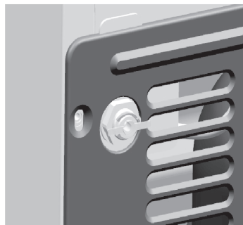
1. Снимите защитное крепление.
