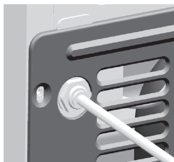
3. Подсоедините мягкую трубку (PE).
