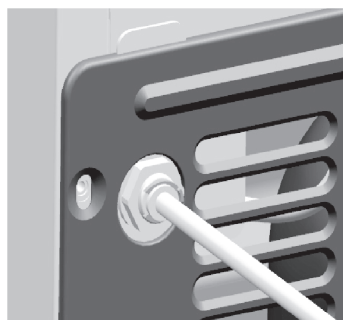
4. Установите защитное крепление.
