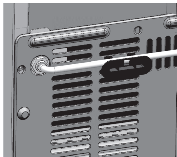
6. Установите мягкую трубку, как показано на схеме.
