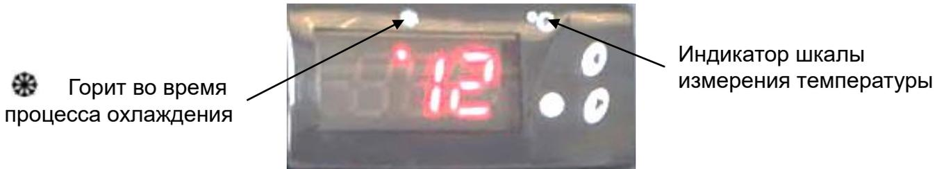
В вашем винном шкафу можно задавать температуру в диапазоне от 5°C до 18°C. Производителем установлена температура охлаждения 12°C.
