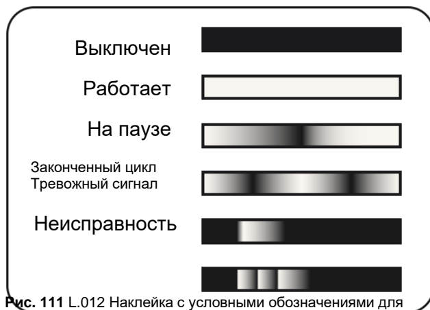
Рис. 111 L.012 Наклейка с условными обозначениями для светового сигнального индикатора L.012
