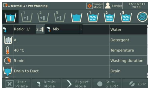
Рис. 71 Редактирование пропорционального забора воды
