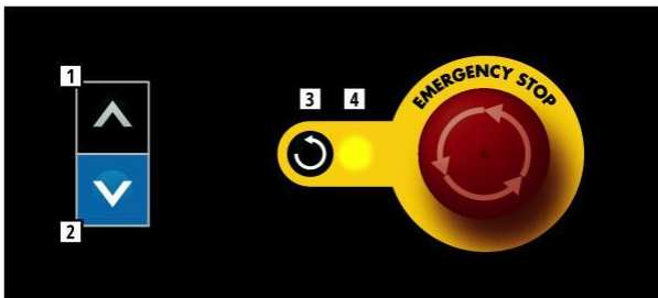
Рис. 119 Кнопка аварийной остановки + панель кнопок наклона у моделей WE110
