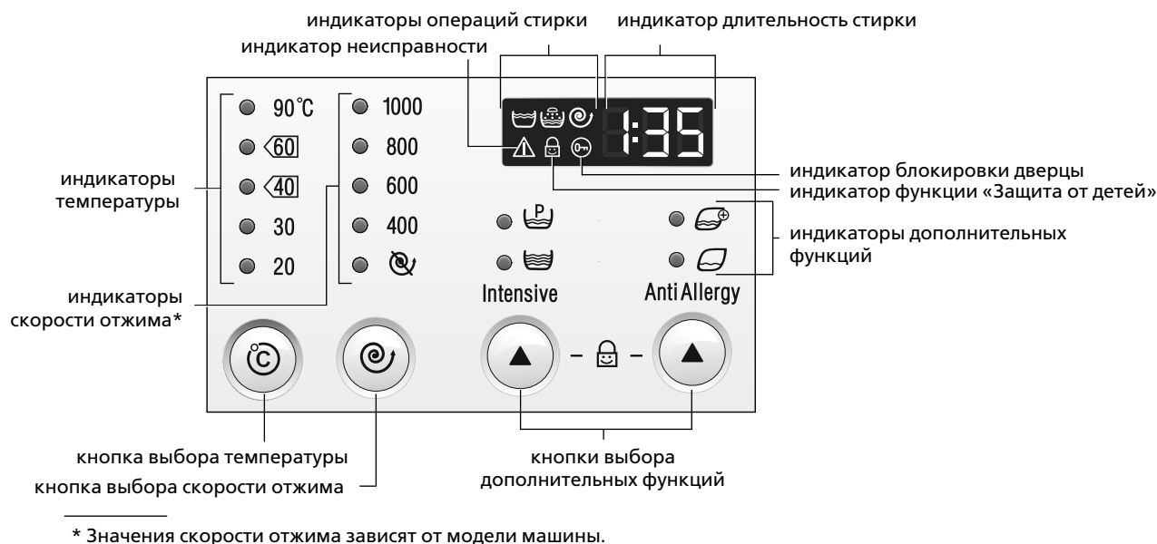
Рисунок 3 — Кнопки управления и зоны индикации
