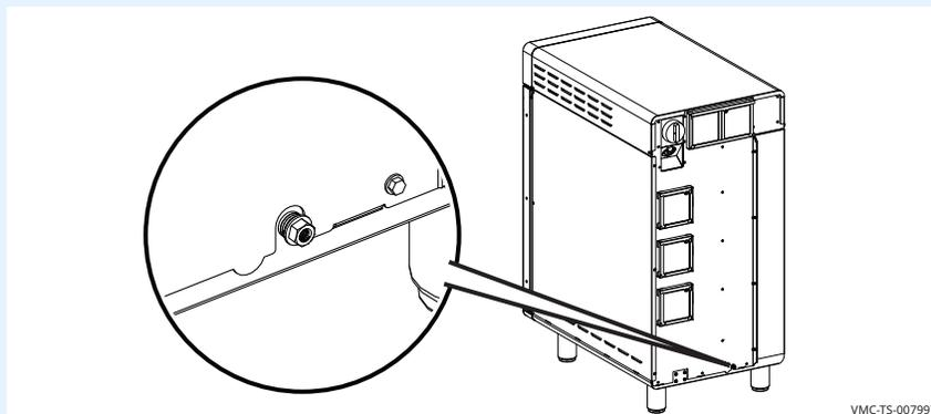
**И** **ПРИМЕЧАНИЕ.** Клемма эквипотенциального соединения расположена в задней части печи снизу.
