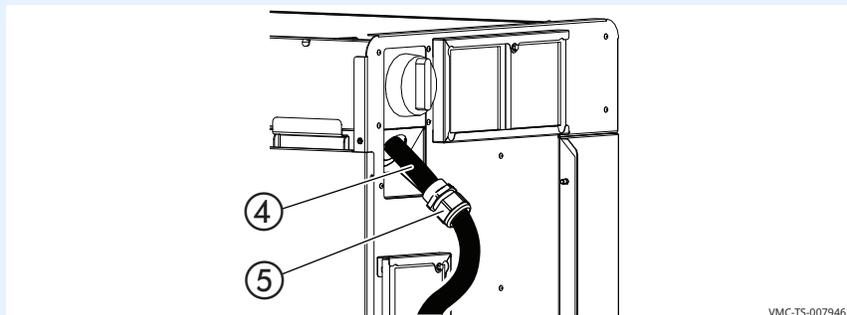
7. **Подключите** шнур электропитания к соответствующим клеммам (L1, L2, L3 и т.д.) в соответствии с местными нормами и правилами.
