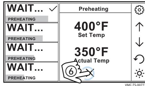
На экране отображается фактическая температура в камере и ее заданная температура. При выборе различных камер выводится информация по температуре для этих камер.
