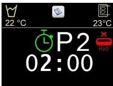
**БОЙЛЕР/ ТАНК НЕ ЗАПОЛНЯЕТСЯ В ТЕЧЕНИЕ УСТАНОВЛЕННОГО ВРЕМЕНИ.**
