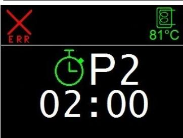
**НЕКОРРЕКТНАЯ РАБОТА ИЛИ ПОЛОМКА ДАТЧИКА ТЕМПЕРАТУРЫ ТАНКА/ БОЙЛЕРА.**
