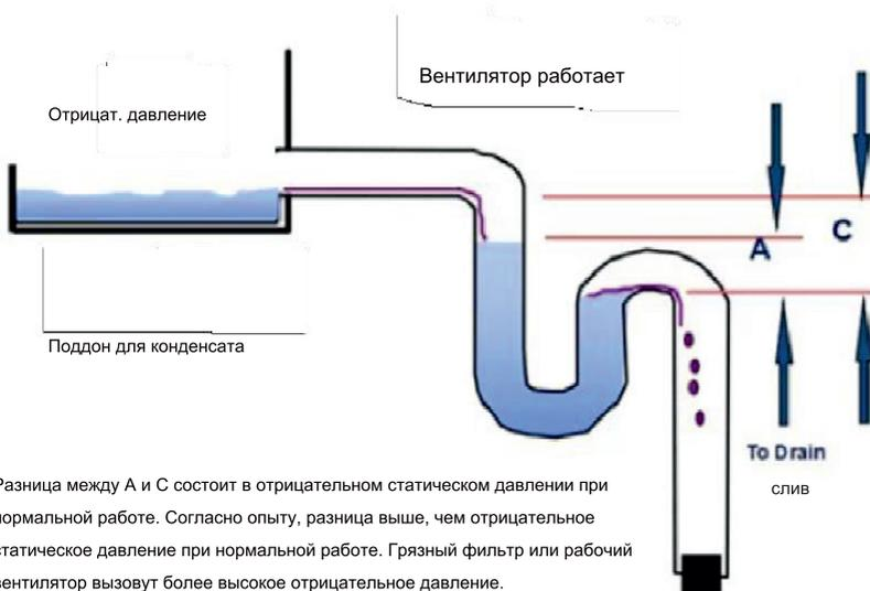
Разница между А и С состоит в отрицательном статическом давлении при нормальной работе. Согласно опыту, разница выше, чем отрицательное статическое давление при нормальной работе. Грязный фильтр или рабочий вентилятор вызовут более высокое отрицательное давление.
