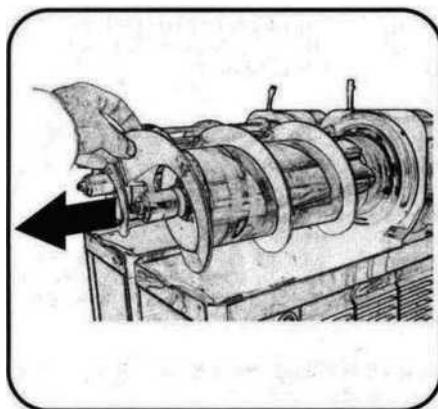
15. Снимите шнек, как показано на рисунке. Снимите большую уплотнительную прокладку с задней панели машины, как показано на рисунке, промойте детали теплой водой с дезинфицирующим средством.
