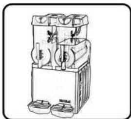
1. Поставьте оборудование на ровную поверхность, оставляя по крайней мере 25 см со всех сторон для циркуляции воздуха, чтобы избежать перегрева. Оптимальная температура в помещении: 25°C-32°C.
