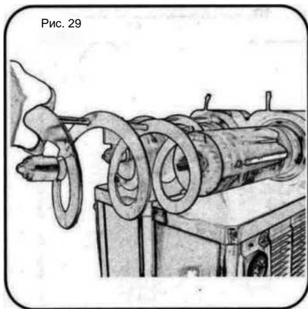
28. Чтобы извлечь шнек, положите пальцы на пластинчатую часть шнека и осторожно потяните ее внутрь, как показано на рис. 28 и 29.
