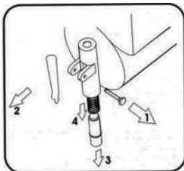
18. Снимите носик и отделите детали в следующем порядке:
