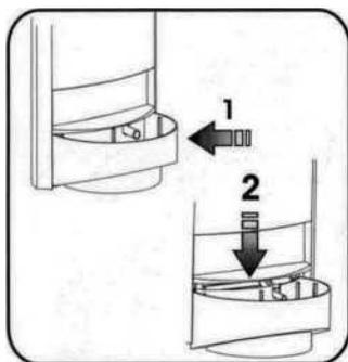
54. Закрепите поддон для сбора капель, вставив крючки в пазы панели. Убедитесь, что отводная трубка установлена правильно ("1"). Опустите поддон для сбора капель вниз, чтобы закрепить его в пазах панели ("2").
