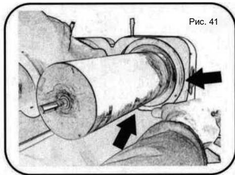
47. Установите прокладку резервуара на прежнее место на задней части трубки испарителя. Как только прокладка резервуара окажется в нужном положении, надавите на нее большими пальцами сначала в нижней части, а затем постепенно в направлении верхней части (отмечая пальцами круг), пока она не будет правильно закреплена на своем месте (см. рис. 40 и 41).
