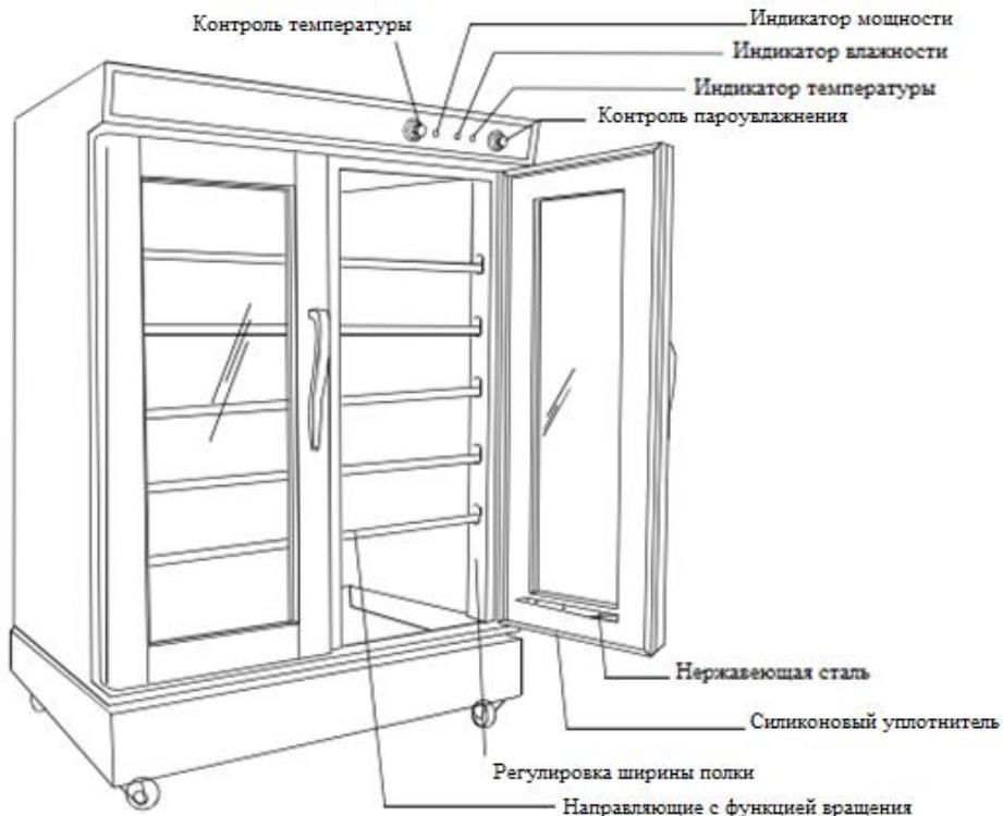
Рис.1 Основные механизмы оборудования
