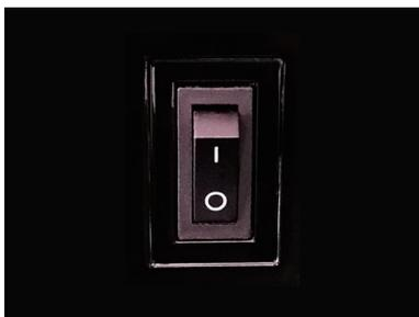
5. После включения питания поверните главный выключатель питания на задней панели машины в положение "I" (как показано на рисунке), а затем нажмите кнопку "Q", чтобы запустить машину.
