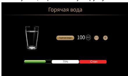
1. Поместите емкость под отверстие для подачи горячей воды (держите отверстие для подачи кофе как можно ближе к чашке, чтобы избежать разбрызгивания горячей воды).
