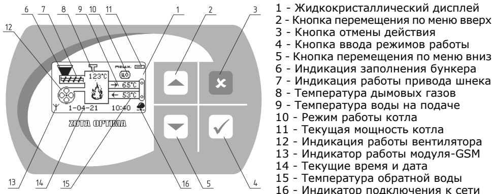
Рис.7 Расположение органов управления и индикации на передней панели пульта
