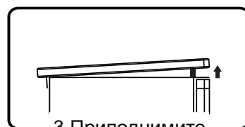
3. Приподнимите верхнюю крышку спереди и установите упор.
