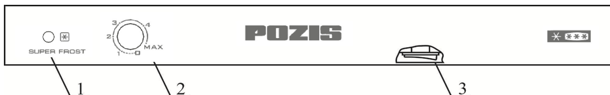
Рис.2 Схема расположения приборов управления и сигнализации 1 — индикаторная лампа; 2 — ручка терморегулятора; 3 — переключатель;
