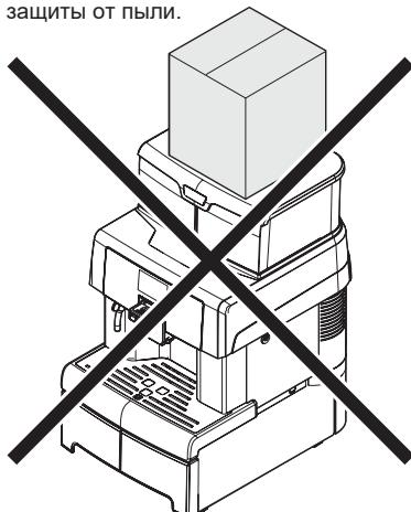
**⚠ Допускается устанавливать друг на друга не более трех машин. Машина должна храниться в оригинальной упаковке, в сухом, защищенном от пыли месте.**
