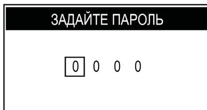
Теперь ПАРОЛЬ может быть установлен. Нажмите кнопку «ВНИЗ» или «ВВЕРХ», чтобы установить нужную цифру. Нажмите кнопку «OK», чтобы подтвердить цифру и перейти к следующей . Выполните процедуры, описанные в предыдущих шагах, чтобы установить выбранные цифры. Вот пример, который объясняет процедуру.
