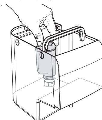
Наполните бак свежей питьевой водой и установите на место. Нажмите "OK", чтобы подтвердить установку фильтра.
