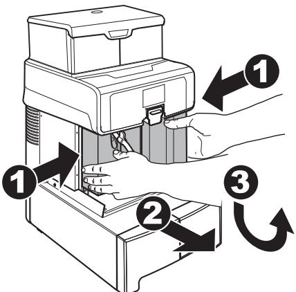
Машина имеет два типа фиксаторов: квадратный для системы Apollo и прямоугольный для монетоприемника.
