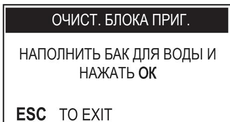
Нажмите кнопку «OK» для начала цикла очистки блока приготовления
