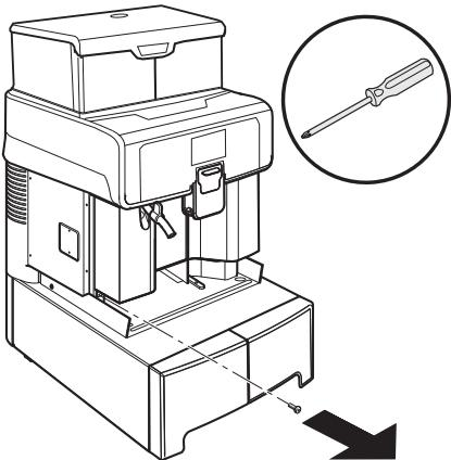
Снимите крышку слева, открутив два винта.
