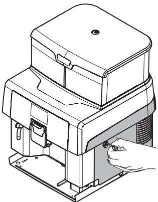
Поднимите внутреннюю кювету за заднюю часть, чтобы снять ее.
