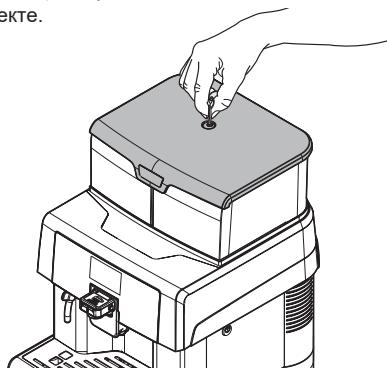
Поднимите и снимите крышку.
