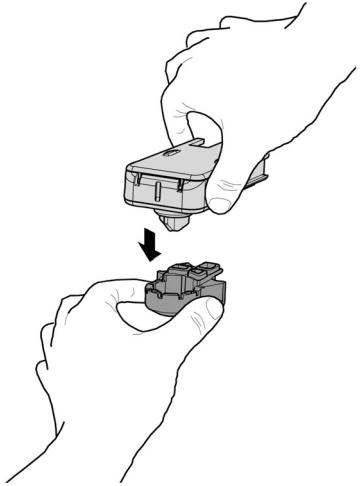
Поверните и поднимите крышку капучинатора и снимите ее с корпуса капучинатора.
