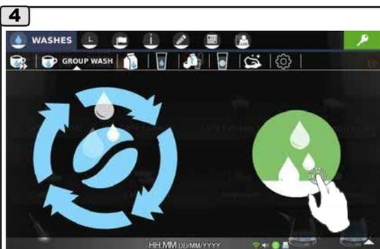
Закройте дверцу отсека кофе без кофеина и нажмите на значок
