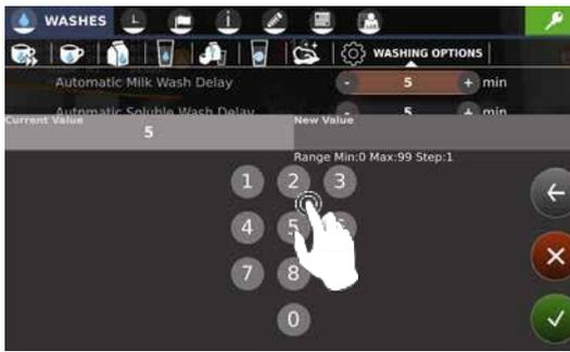
**Автоматическая отсрочка промывки молочного контура-** (задается время отсрочки промывки, между минимальным и максимальным значениями).
