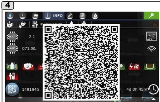
QR-код появится на экране и после считывания мобильным устройством передаст данные по машине.
