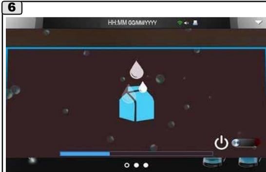
На время цикла на сенсорном экране появляется символ промывки молочного контура. Индикатор выполнения показывает время до окончания цикла.
