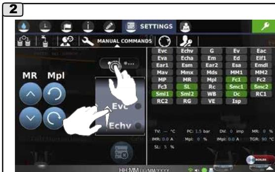
Нажмите на значок
