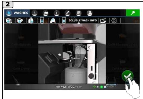
На экране отображается порядок промывки миксера. После выполнения каждой инструкции нажимайте на значок
