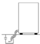
**LA VIDANGE DE LA CUVE SE FAISANT PAR GRAVITÉ, L'ÉVACUATION DOIT DONC SE SITUER À UN NIVEAU PLUS BAS DE LA BASE DE L'APPAREIL.**
