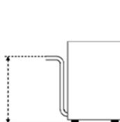
**DANS CE CAS, L'ÉVACUATION DOIT SE SITUER À UNE HAUTEUR MAXIMALE DE 1 MÈTRE. IL FAUT TOUJOURS VÉRIFIER QUE L'ÉVACUATION NE SOIT PAS OBSTRUÉE ET/OU ENTARTRÉE.**
